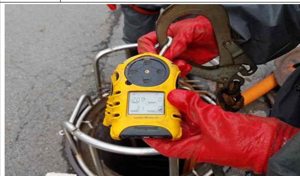
내용 출입전 산소 농도 측정
